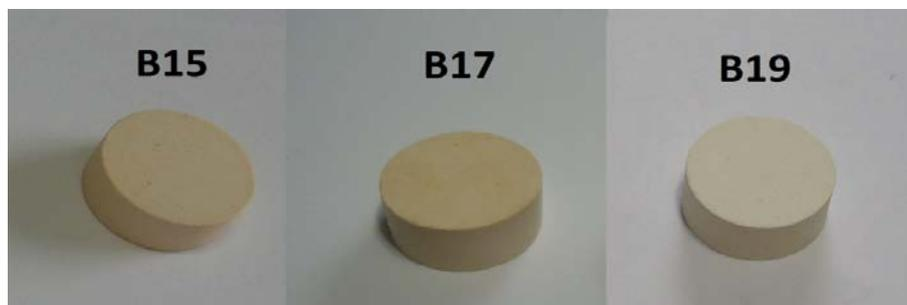
Figura 4.20 – Cerâmicas sinterizadas do Experimento B.
