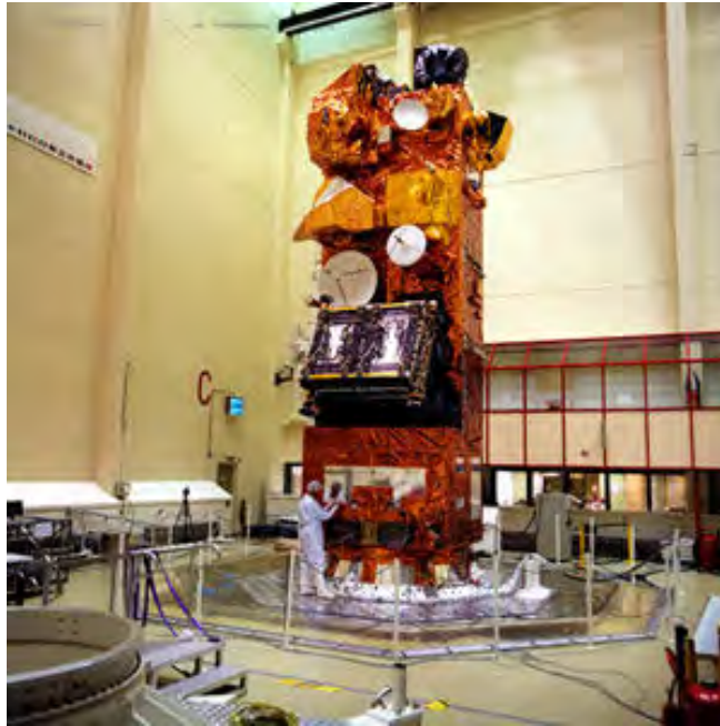
Figura 7.7 - Modelo de Voo do Envisat sendo ensaiado no HYDRA Fonte:ESA (2012)
