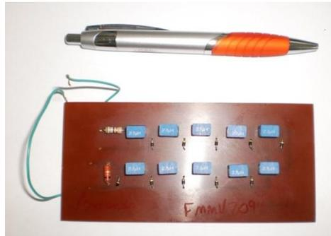
Figura 2 . Montagem experimental da LTNL usando varicap FMMV109.
