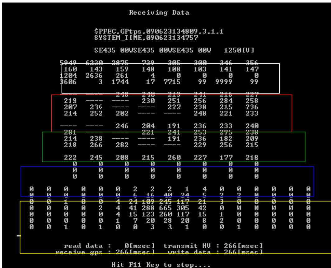
Figura 22– Display de verificação da contagem de muons.
