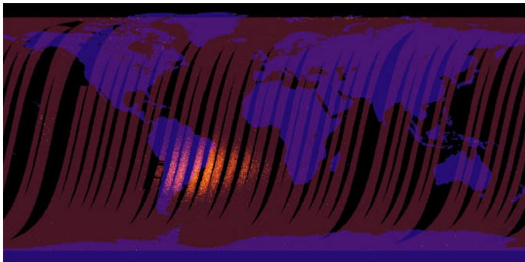
**Figura 2 – Anomalia Magnética do Atlântico Sul – AMAS. A Figura mostra dados do satélite *Multi-angle Imaging SpectroRadiometer* (MISR) de radiação produzida pela passagem de protons energéticos. Fonte: <http://earthobservatory.nasa.gov>.**
