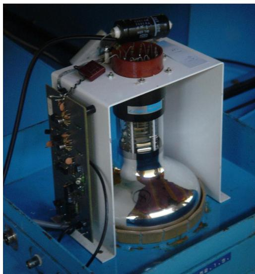
**Figura 18 – Foto da fotomultiplicadora utilizada no DMM-P e DMM-E.**
