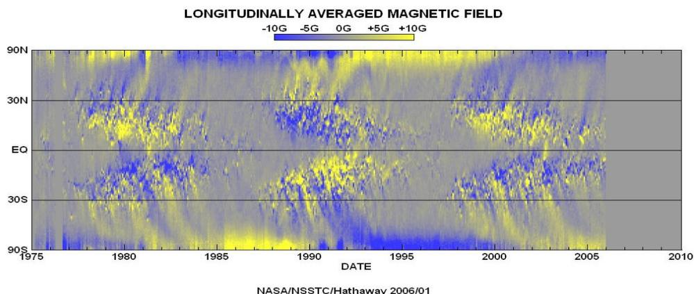
**Figura 5 – Diagrama da Borboleta. É possível ver o ciclo solar através das cores em azul e amarelo pares de manchas. As manchas nascem em altas latitudes e migram para o equador. Campo magnético medido em Gauss. FONTE:**
