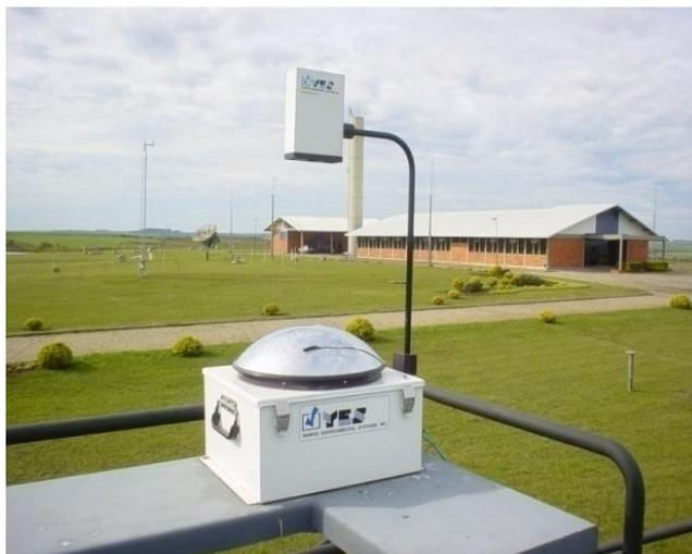
Figura 2.3 – Imageador TSI-440 instalado na estação do Projeto SONDA no Observatório Espacial do Sul, em São Martinho da Serra – RS.
