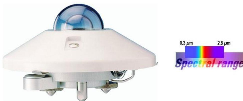
Figura 5.7 – Piranômetro CM21 (Kipp & Zonen) instalado nas estações da rede SONDA e sua faixa espectral de operação para medidas de irradiância solar global.
