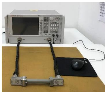
**Figura 2** – Guia de ondas acoplado ao analisador de rede vetorial
