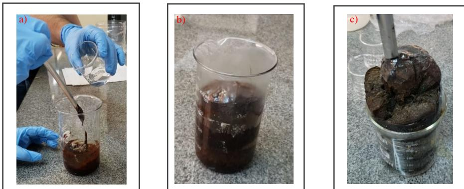
**Figura 1.** Síntese da espuma: a) adição de catalisador; b) reação e expansão; c) espuma.
