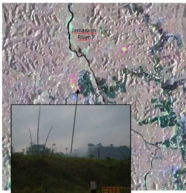
Figura 5.4.6 - Composição colorida PALSAR ScanSAR de 10/11/04 (B), 10/02/04 (G), 10/08/07(R) e respectiva foto de campo, exemplificando áreas de desmatamento recente no município de Itaituba (PA)
