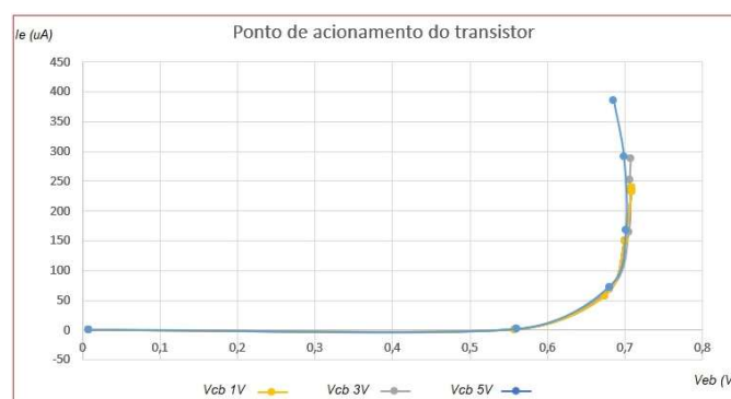
Figura 6. Curva de acionamento do transistor obtido nos testes elétricos.
