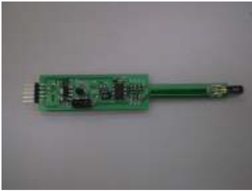
Fig. 4. Placa do termohigrômetro.
