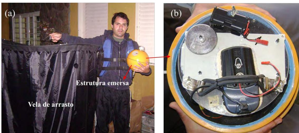
Figura 3.5 - Derivador lagrangeano: (a) estrutura emersa e vela de arrasto; (b) carga útil.
