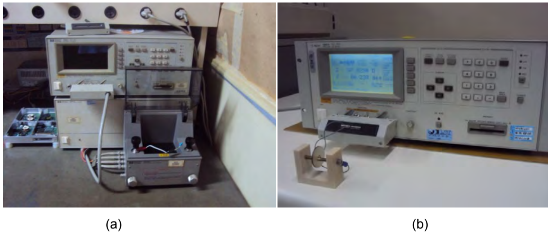
Figura 5.5 – Equipamentos usados para as medida de C \times f (a) capacitor cerâmico conectado diretamente ao módulo de acoplamento (b) PZT conectado ao módulo utilizando uma porta amostra.
