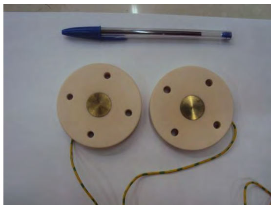
Figura 5.2 - Porta amostra usado para o PZT na medida de C \times V .
