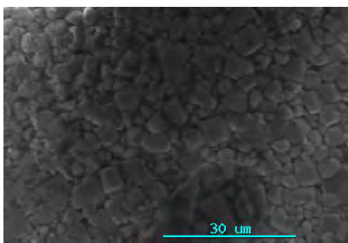
Figura 6.41 – Imagem obtida por MEV de um capacitor cerâmico comercial.
