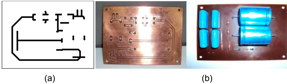
Projeto da fonte de alta tensão para medida de breakdown (a) layout desenhado no tango PCB (b) foto da placa de circuito impresso.
