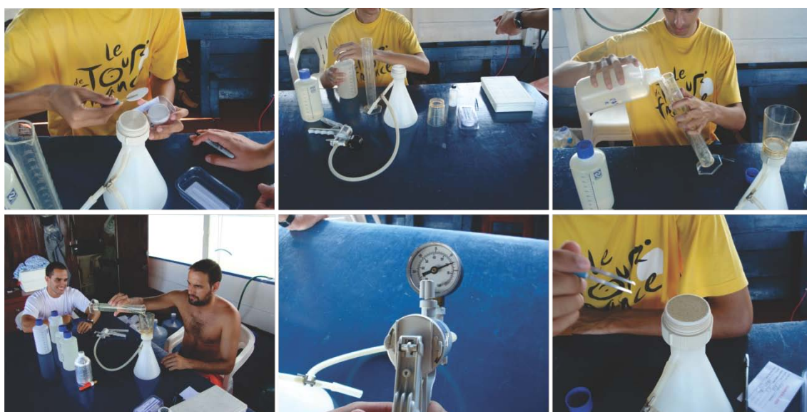
Figura 3.7 - Procedimentos de filtragem das amostras de água para a quantificação da Chl-a e TSS.
