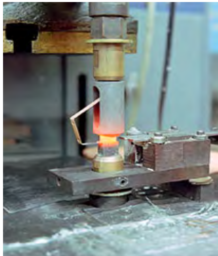
Figura 2.18- Brasagem por resistência de uma junta Fonte: Contact Technologies (2001) [36]
