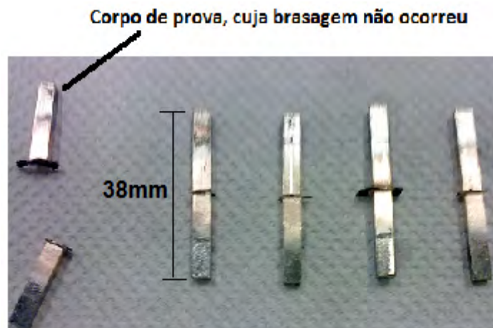
Fig. 4.12- Corpos de prova falhos, obtidos com o filme de diamante fornecido pela empresa Clorovale
