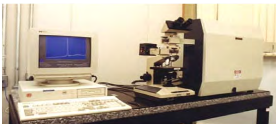
Fig. 3.4- Equipamento para análise Raman disponível no LAS/INPE Fonte: Barbieri (2007) [19]
