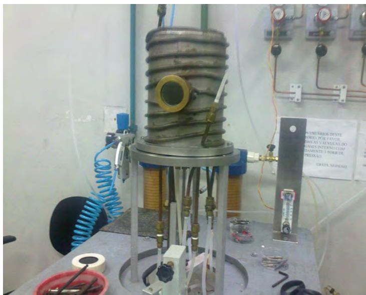
Fig. 3.1- Reator HFCVD utilizado para obtenção do filmes de diamante
