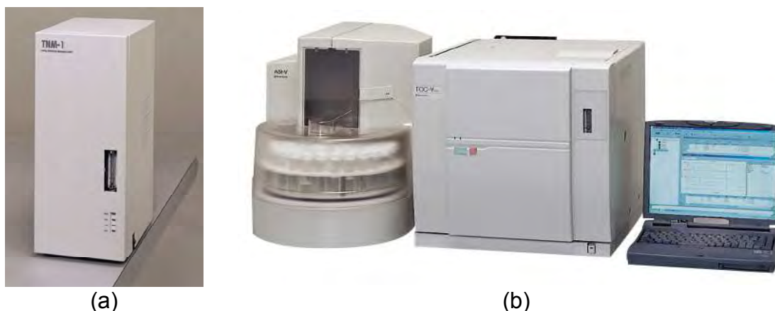
Figura 4.1 – Analisador de nitrogênio total TNM-1 (a) e analisador de carbono orgânico total- TOC – V CPN (b), da marca Shimadzu.
