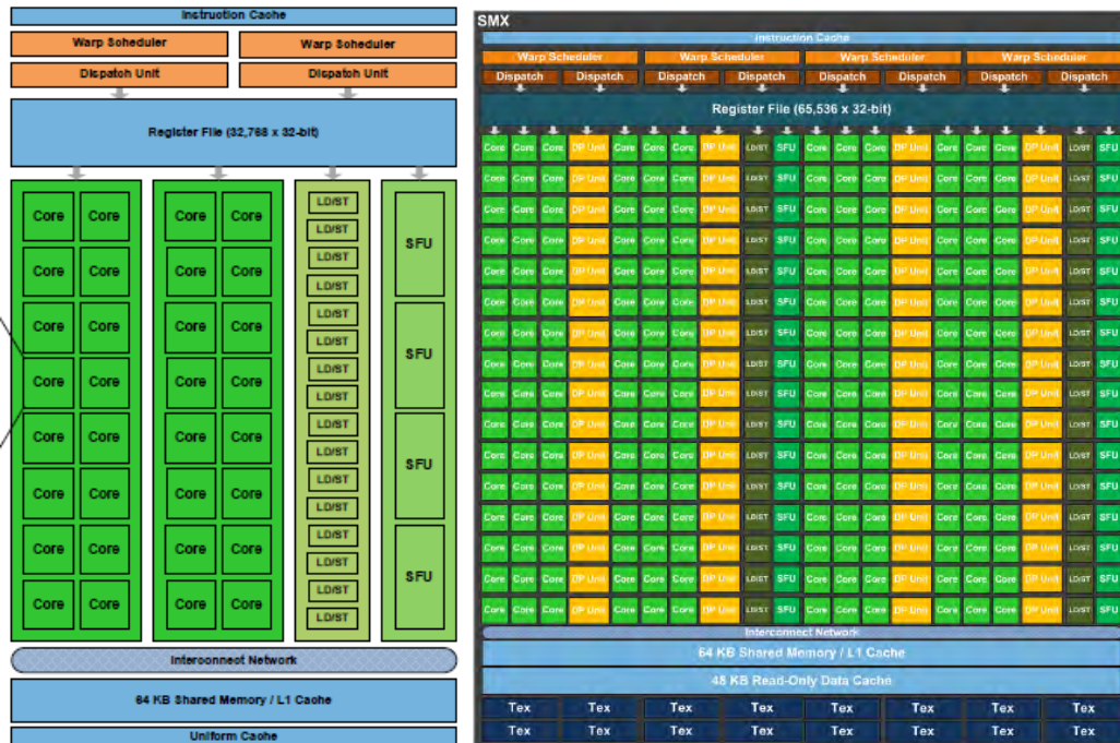
Figura C.8 - Um bloco multiprocessador (SM), (a) da arquitetura Fermi, (b) da arquitetura Kepler Fonte: NVIDIA (2012)
