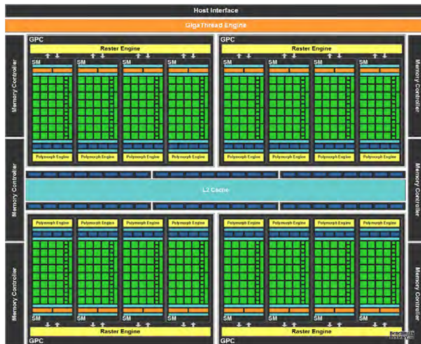
Figura C.6 - Arquitetura Fermi Fonte: NVIDIA (2012)
