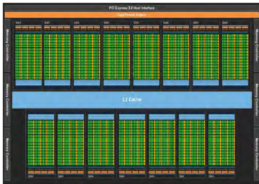
Figura C.7 - Arquitetura Kepler Fonte: NVIDIA (2012)
