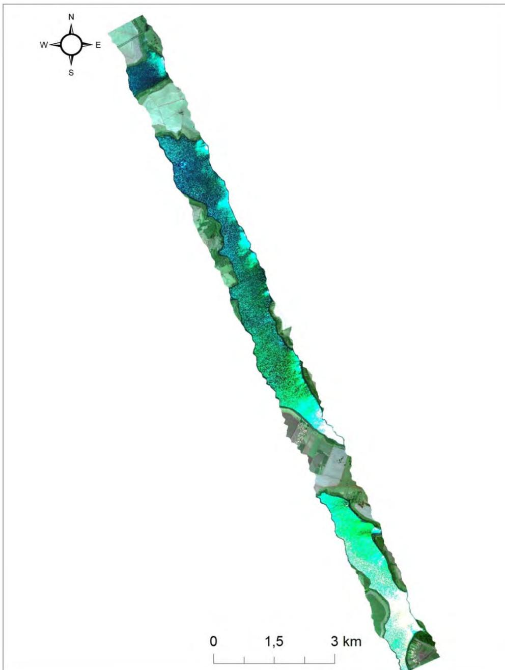
Figura A.8 - Imagem D *deglint* obtida pelo método de Kutser et al. (2009) modificado composição cor verdadeira (R 638 nm; G 548 nm; B 460 nm).
