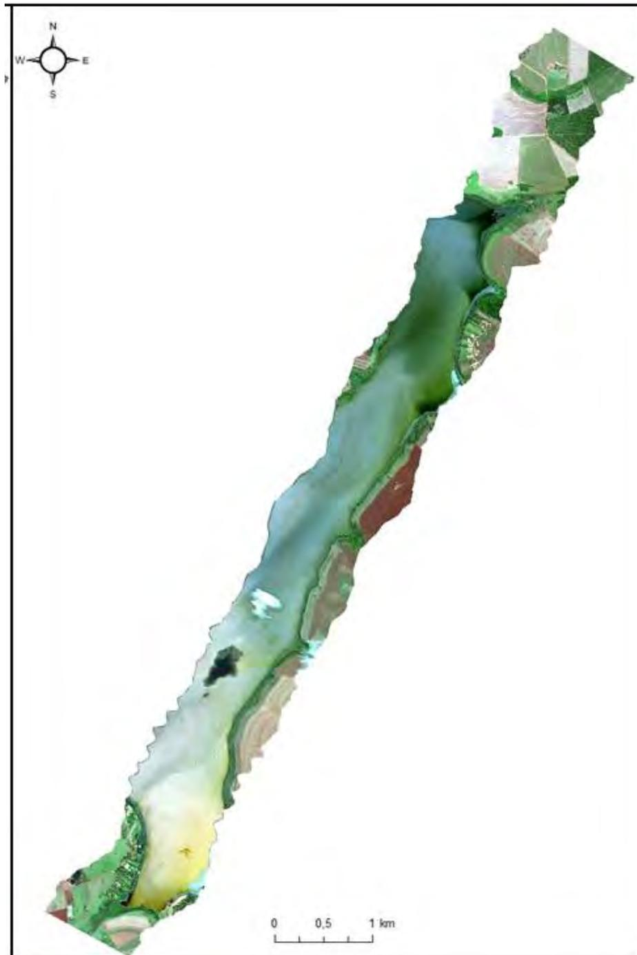
Figura A.2 Imagem G *deglint* obtida pelo método de Goodman et al. (2008) composição cor verdadeira (R 638 nm; G 548 nm; B 460 nm).
