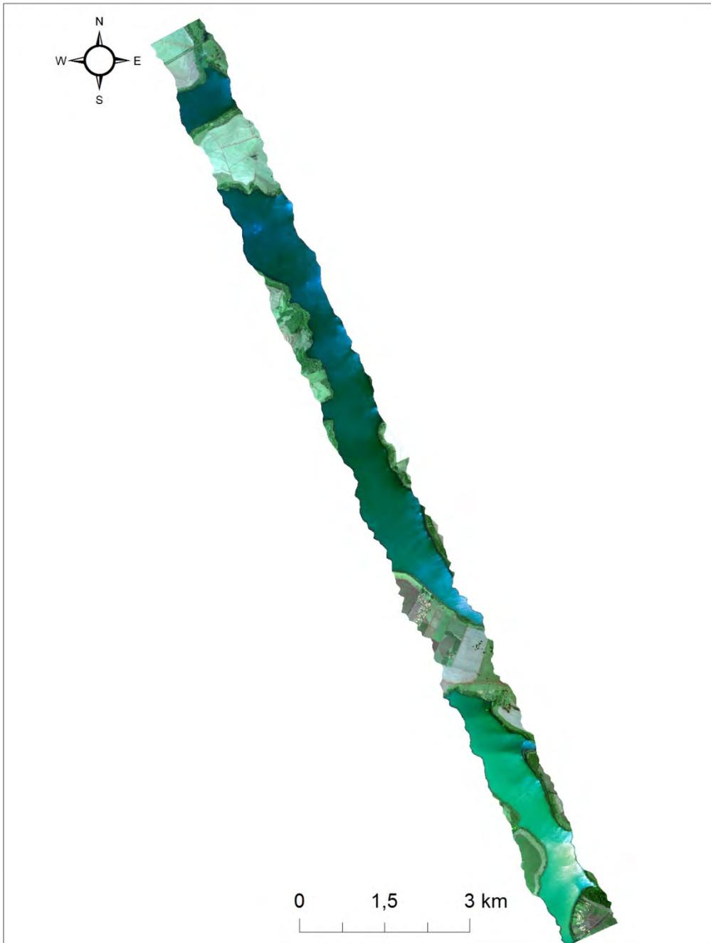
Figura A.7 - Imagem D *deglint* obtida pelo método de Kutser et al. (2009) modificado composição cor verdadeira (R 638 nm; G 548 nm; B 460 nm).
