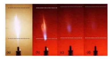
Figura 2.19 - Aparência de chamas de propano com ar diluído com nitrogênio pré-aquecido. a)  $20.9\%~O_2;~b)~16.8\%~O_2;~c)~12.8\%~O_2;~d)~10.0\%~O_2.$
