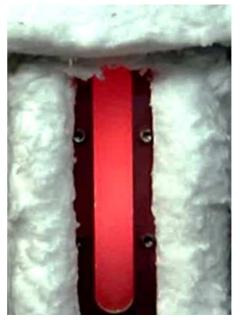
Figura 4.33 - Aparência da chama durante o regime de transição para  $\lambda$  = 1,20 e condição de combustão sem chama visível para  $\lambda$  = 1,21. Potência térmica em ambos os casos igual a 4 kW.
