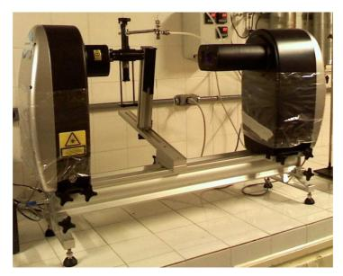
Figura 3.8 - Sistema de difração laser Malvern *Spraytec*® (2007).
