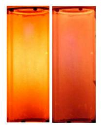
Figura 2.22 - Aspecto da chama para duas condições de operação,  $\lambda$  = 1,3 e  $\lambda$  = 2,6, respectivamente.  $T_{aq}$  = 600 K e potência térmica = 8 kW em ambos os casos. Fonte: Castela (2010).
