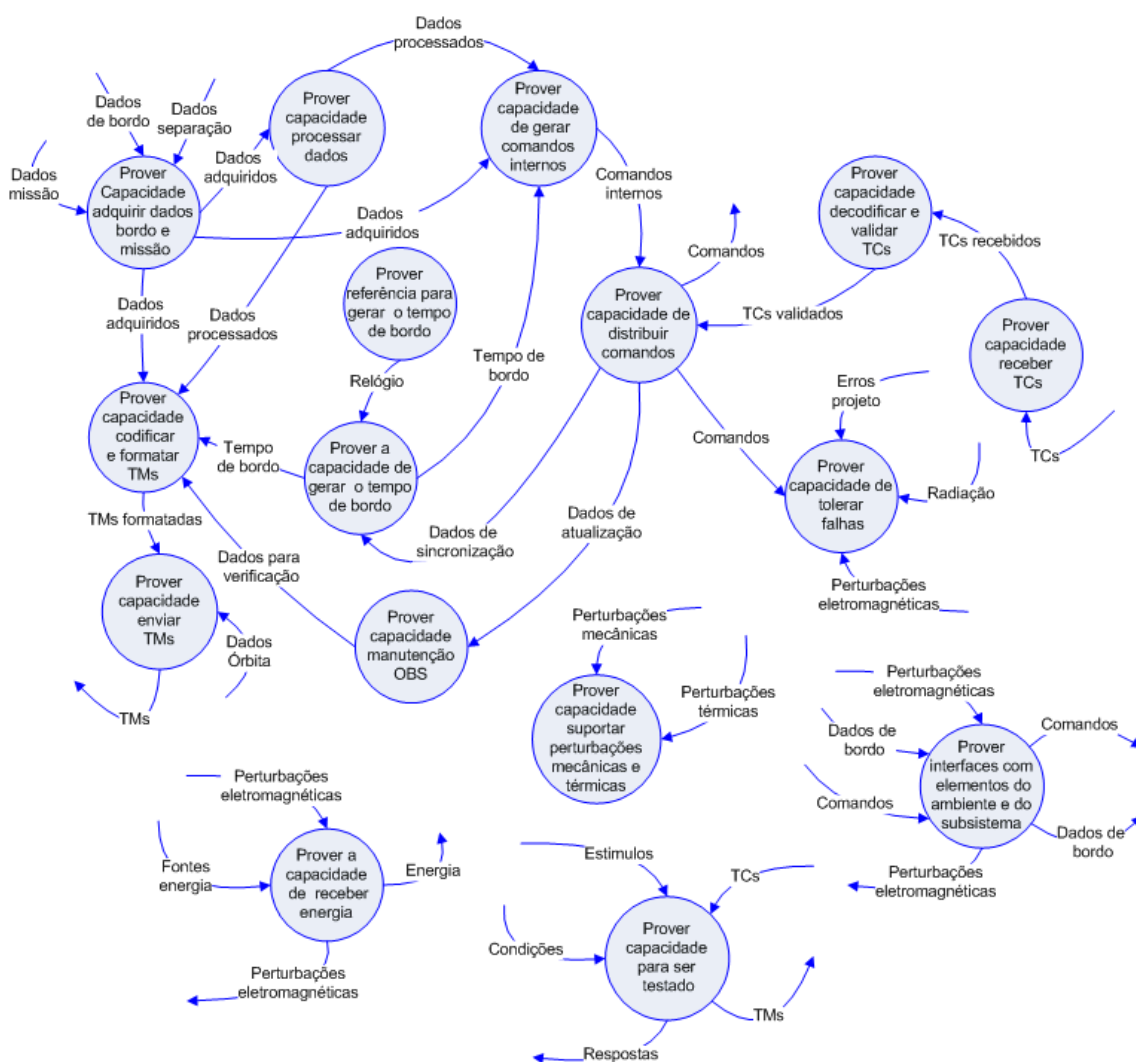
Figura 3.6 – Diagrama de decomposição funcional do subsistema
