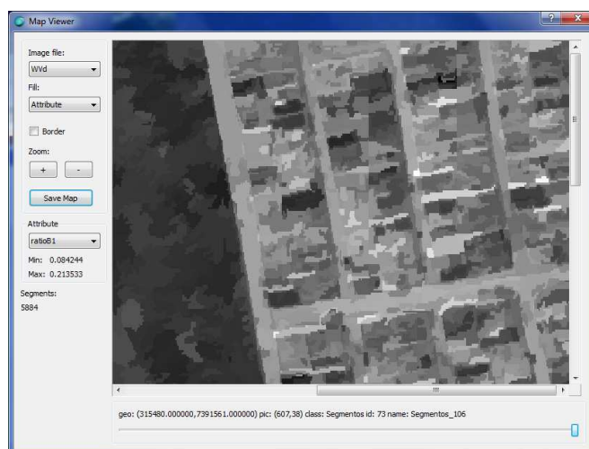
Figura 3.10 – Visualização do atributo "razão da banda 1" (sensor WorldView-II) em níveis de cinza. Os segmentos mais escuros correspondem às classes Solo Exposto e Telha Cerâmica.
