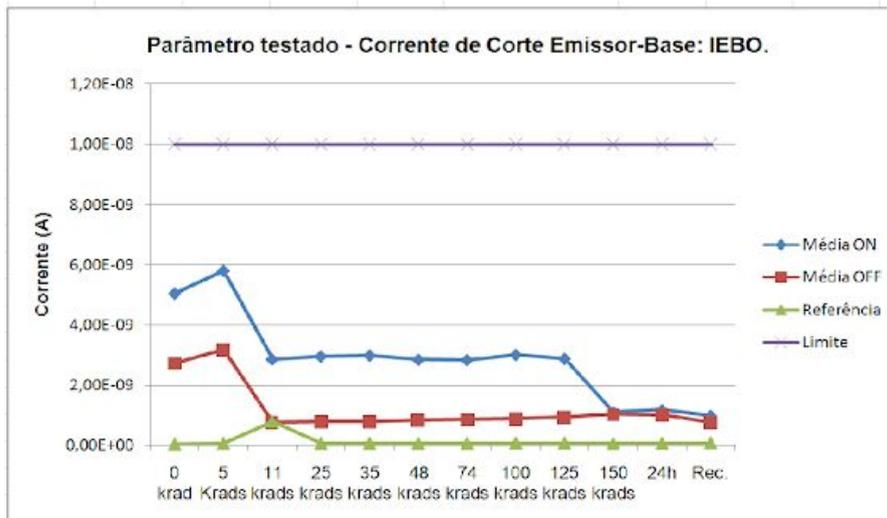
Figura 4. Gráfico do parâmetro Corrente de Corte Emissor-Base.
