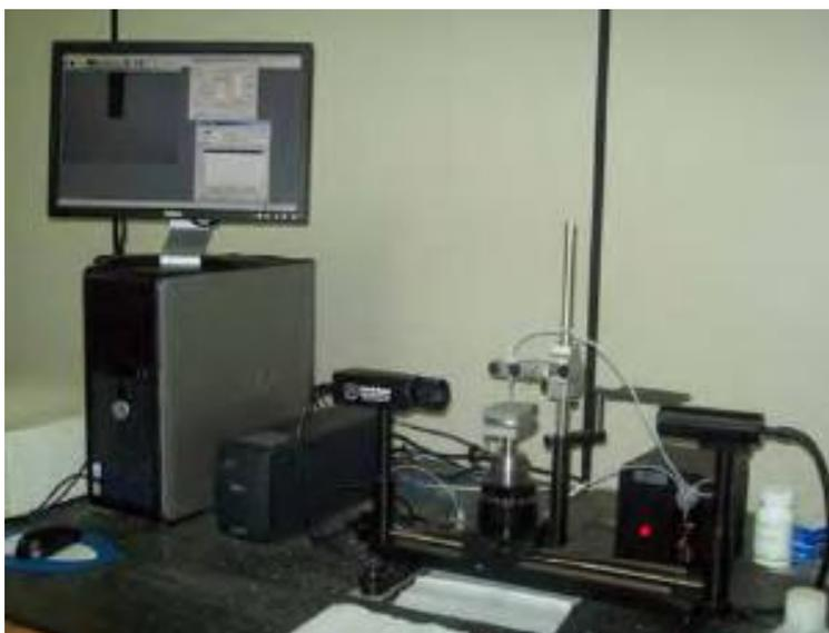
Figura 3.7 – Sistema utilizado para medição da molhabilidade dos filmes existente na FEG/UNESP.
