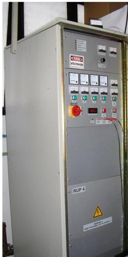
Figura 4.5 – Fotografia do Pulsador de alta tensão negativa RUP-4.
