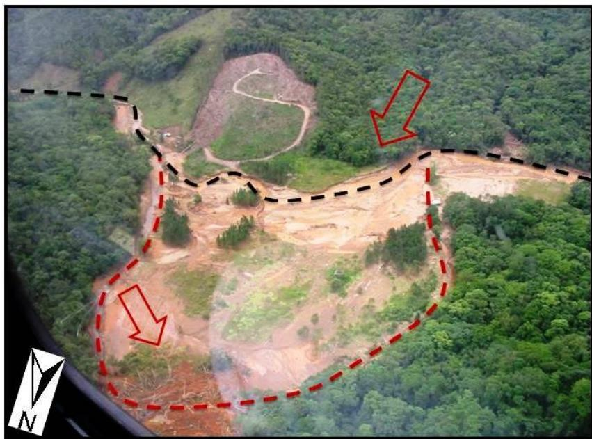
Figura 5.27 – Fotografia de campo da cicatriz de deslizamentos sobre o Ribeirão do Baú.
