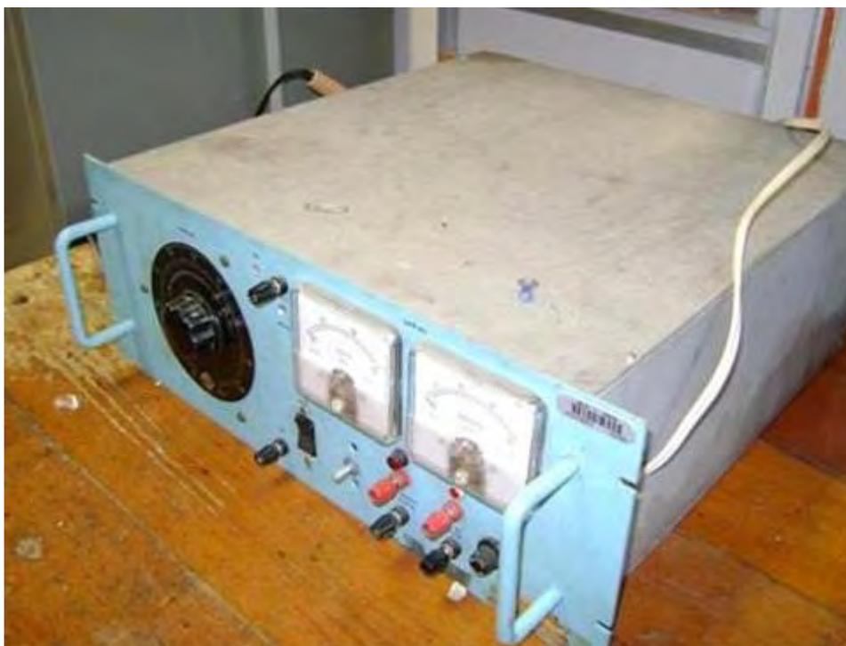
Figura 3.15- Fonte de potência para o aquecedor do propulsor.
