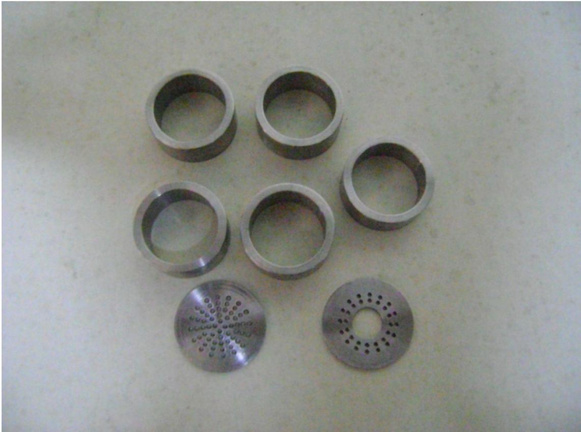
Figura 3.4- Telas e anéis do leito catalítico.
