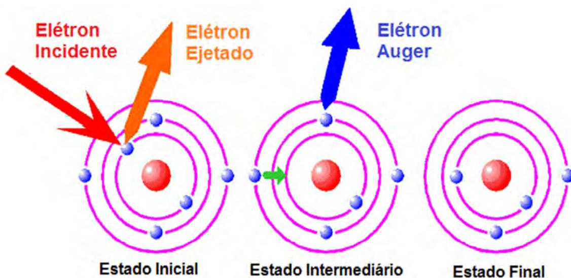
Figura 2.5 – Processo de emissão de elétron Auger.
