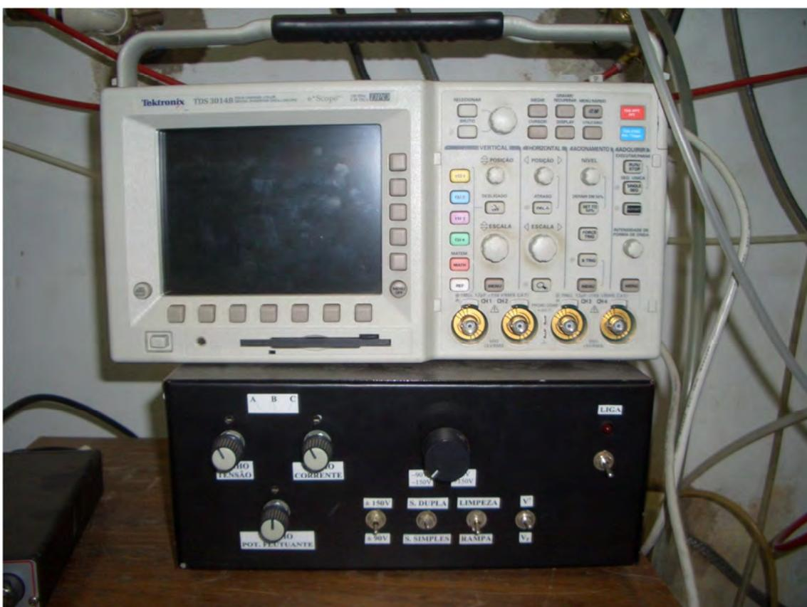
Figura 3.5 – Osciloscópio (acima) e fonte da sonda de Langmuir (abaixo). Parâmetros utilizados na fonte da sonda: Ganho de tensão e corrente “A”, variação de tensão de +90 V a -90 V.
