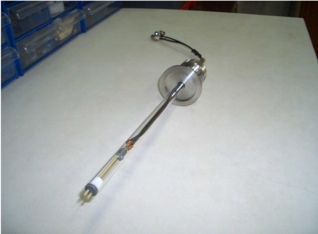
Figura 2.1 – Foto de uma sonda de Langmuir de ponta dupla.
