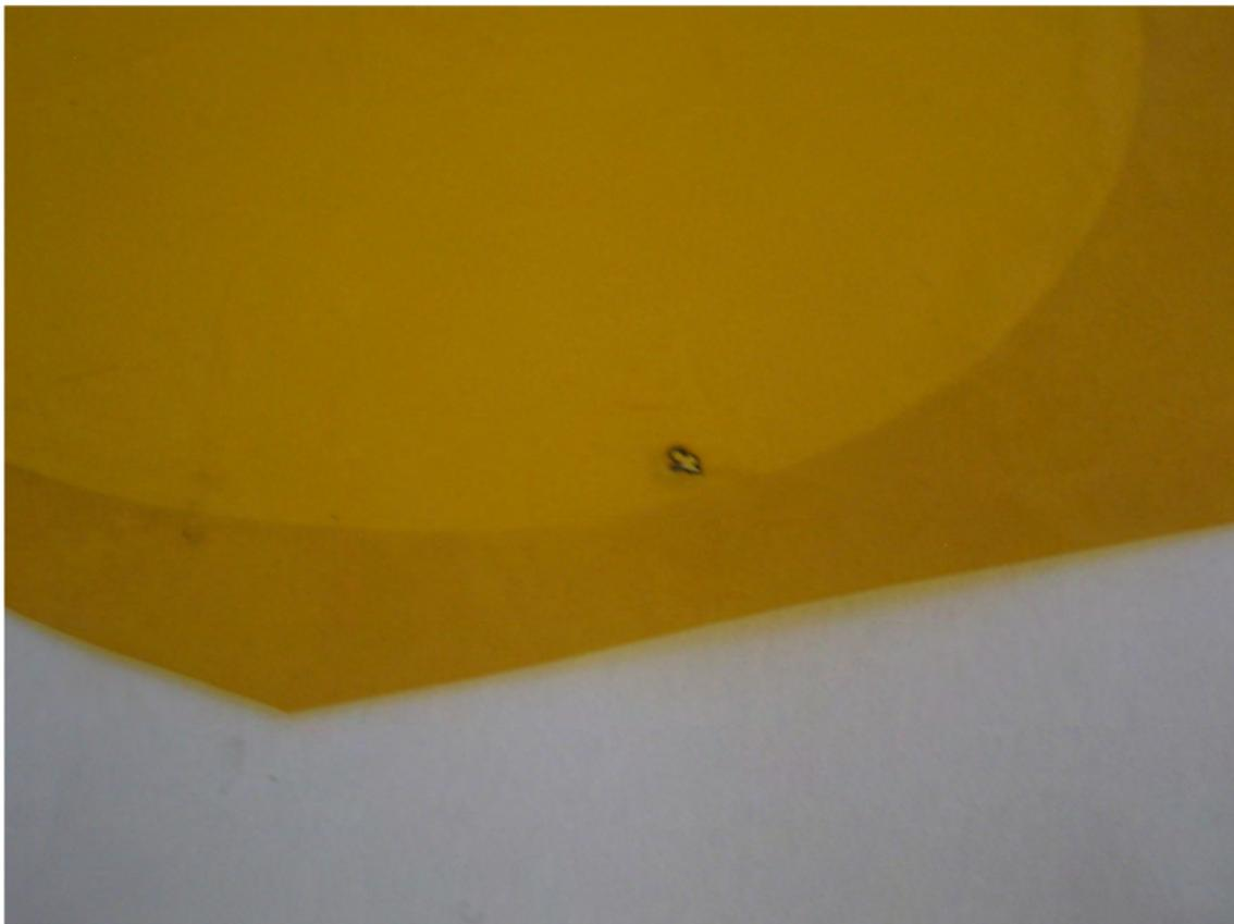
Figura 4.9 – Perfuração causada por rompimento de arco elétrico em folha de Kapton.
