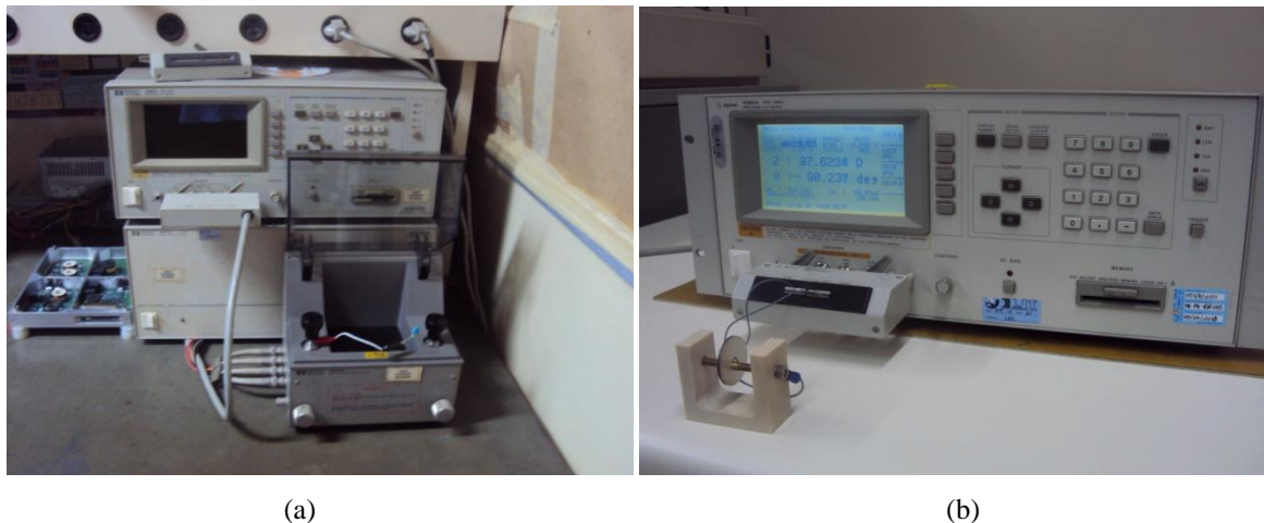
Figura 5. Caracterização em frequência usando a ponte RLC (a) capacitor cerâmico comercial (b) PZT.
