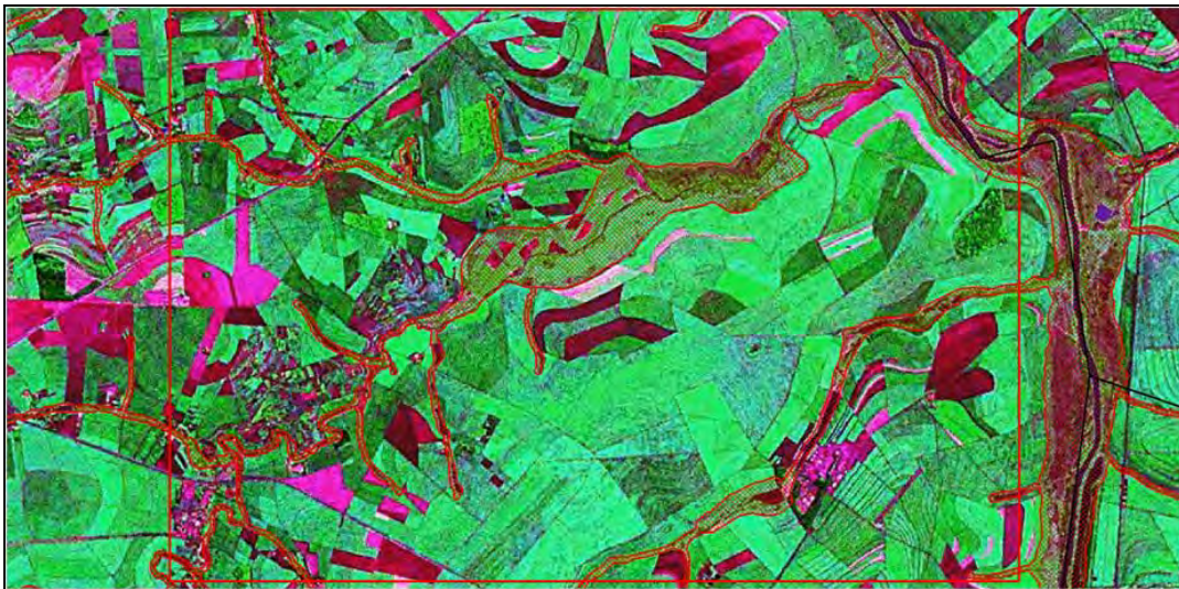
Figura 5.12 - Delimitação das APPs ciliares. As linhas tracejadas na cor vermelha representam os buffers pré-definidos a partir da largura dos cursos d'água, especificadas nas Resoluções CONAMA.
