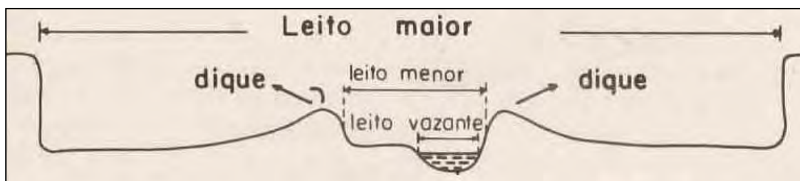
Figura 2.2 - Tipos de leitos fluviais. Distinção entre leitos vazante, menor e maior (Figura sem escala e com tamanho exagerado).
