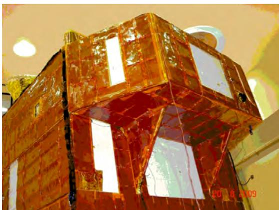
Figura 3.1 – Modelo térmico-estrutural do satélite CBERS 3, desenvolvido sob a coordenação do Grupo - GTER/DMC/ETE.
