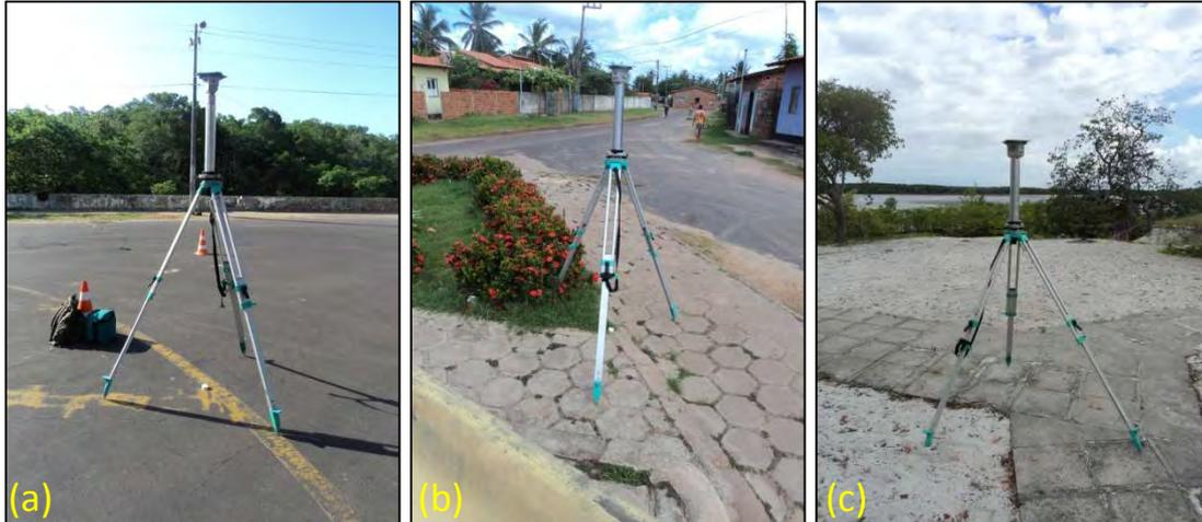
Figura 4.3 - Exemplos de feições (a), (b) e (c) escolhidas para a implantação e aquisição de pontos com o GPS.
