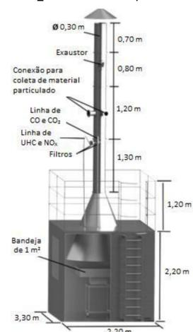
Figura 1- Aparato experimental para queima de biomassa.
