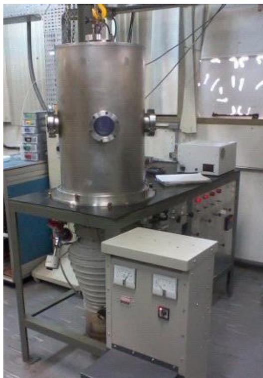
Figura 3.1 - Sistema de deposição.
