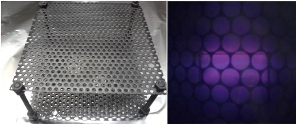
Figura A.1 – Catodo de placas paralelas
