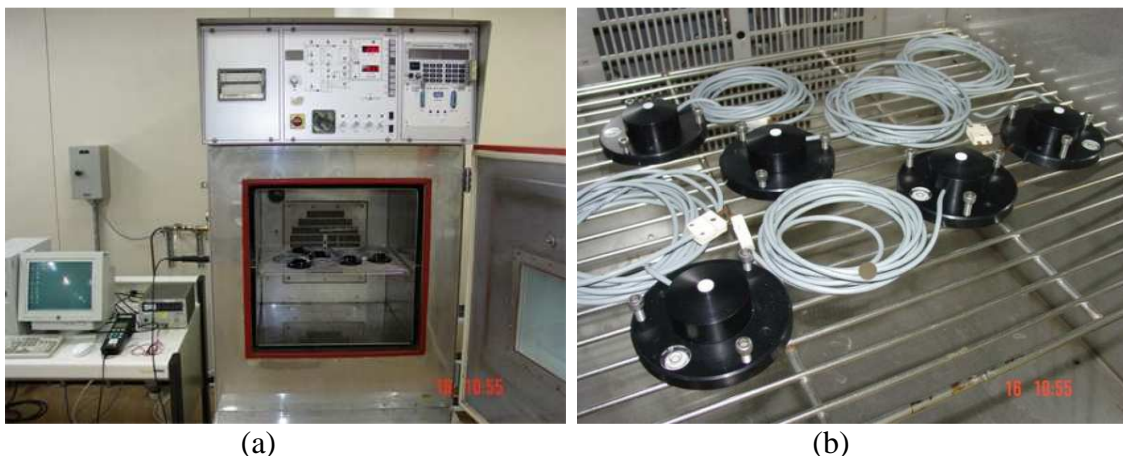
Figura 66 - Ensaio ambiental termoclimáticos. (a) Câmara Heraeus Votsch. (b) protótipos dentro da câmara após o término do teste.
