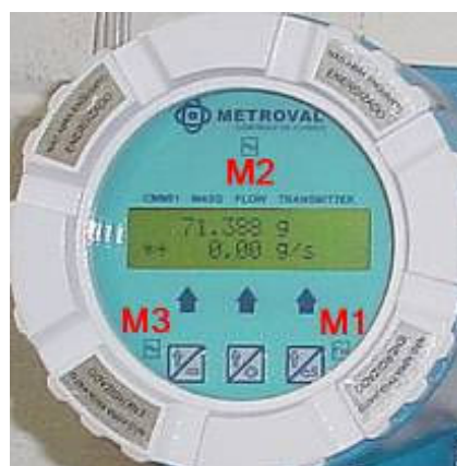
Figura 5.13 - Sensores magnéticos dos medidores de vazão.
