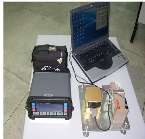
Fig. 1 - Receptor GPS, conjunto IMU e computador
