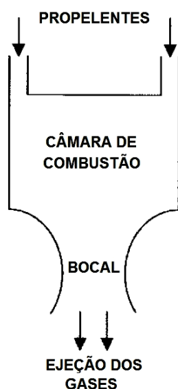
Figura 2.14 – Representação esquemática do sistema propulsivo químico. Fonte: Adaptada de Tewari (2007).
