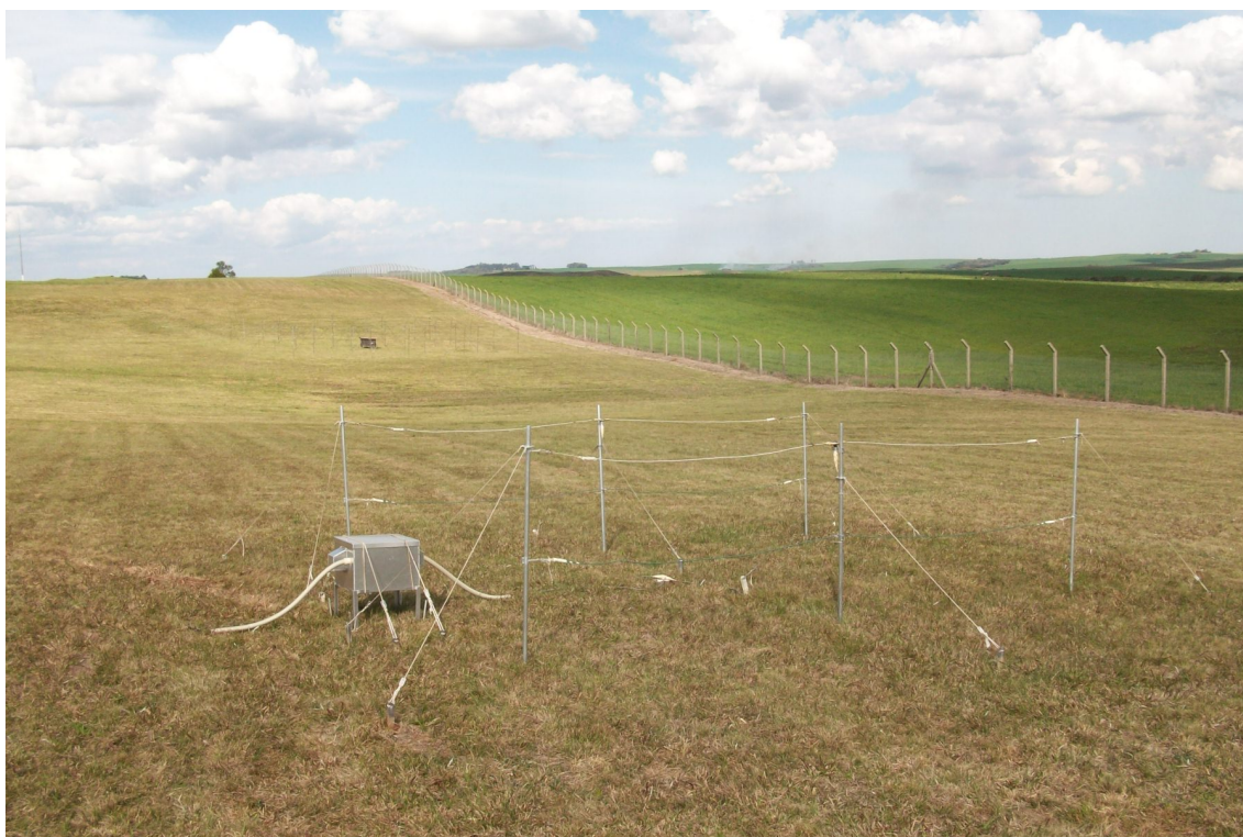
Figura 4.2 - Riômetro convencional instalado no Observatório Espacial do Sul (OES/CRS/CCR/INPE - MCT, 29^{\circ} 4' S , 53^{\circ} 8' O ), em São Martinho da Serra, RS - Brasil.
