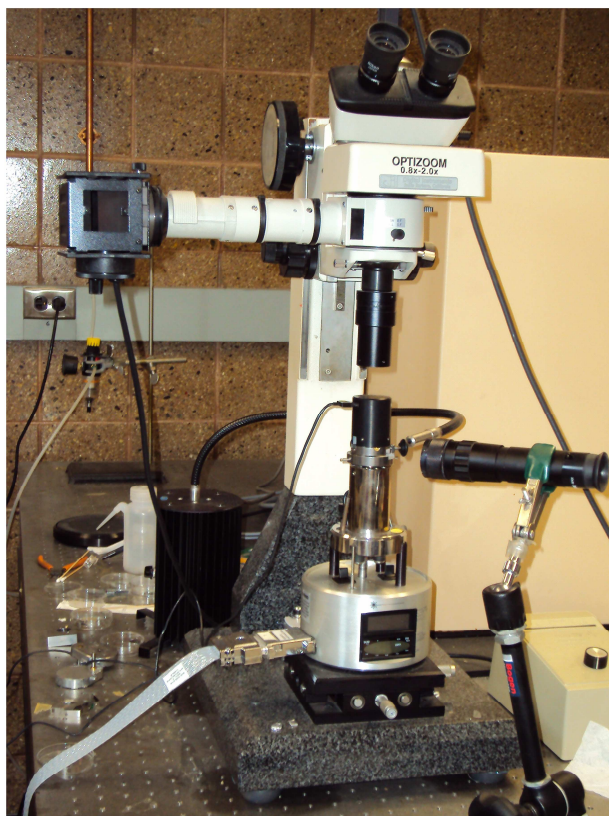
Figura 3.4 - Equipamento nanoindentador e AFM fabricado pela Hysitron Triboscope .
