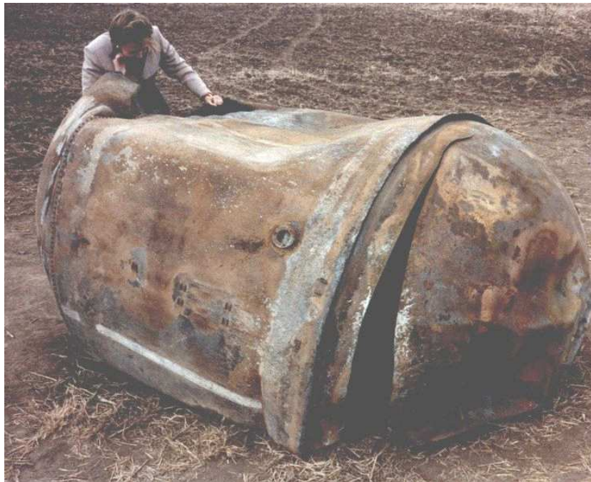
Figura 2.27 – Tanque de Aço Inoxidável do Segundo Estágio do Foguete Delta 2, encontrado perto de Georgetown, Texas.
