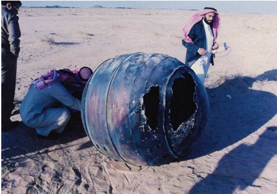
Figura 2.31 – Motor de Titânio do Terceiro Estágio do Foguete Delta 2. Fonte: NASA (2009).
