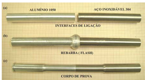
Figura 5 – Interfaces dos pinos que foram unidas (a); rebarba gerada pelo processo (b); corpo de prova para ensaio e tração (c); (Amostras sobre papel milimetrado).
