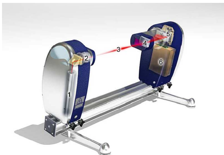
Figura 8.3 - Sistema de difração laser Spraytec da empresa Malvern: (1) Fonte de luz laser, (2) óptica de colimação, (3) região de medição, (4) lentes coletoras de dados, (5) detector de espalhamento de luz, (6) eletrônica para aquisição de dados.
