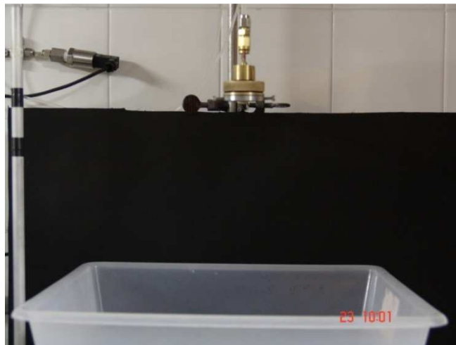
Figura 6.2 - Montagem do arranjo experimental para realizar a medição do ângulo de cone.
