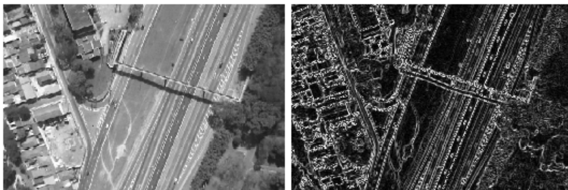
Figura 3.7 - Uma imagem aérea e suas bordas extraídas pelo operador Canny sem histerese.
