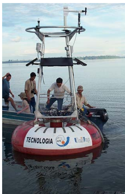
Figura 6 – O sistema SIMA em operação em reservatório de usina hidroelétrica.
