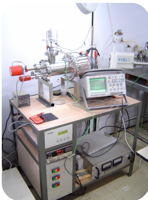
Figura 4.5 - Bancada de medição de emissão de campo.
