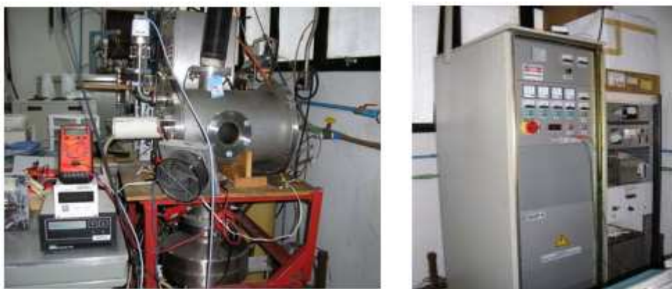
Figura 3.1 – a) sistema 3IP de energia moderada, e b) do pulsador RUP-4, existentes no LAP.
