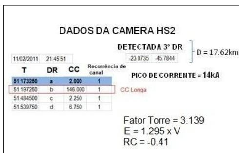
Figura 4.17 - Dados de entrada do programa para o cálculo de carga e intensidade média de corrente, sendo eles: fator torre, razão V/E, distância e RC.
