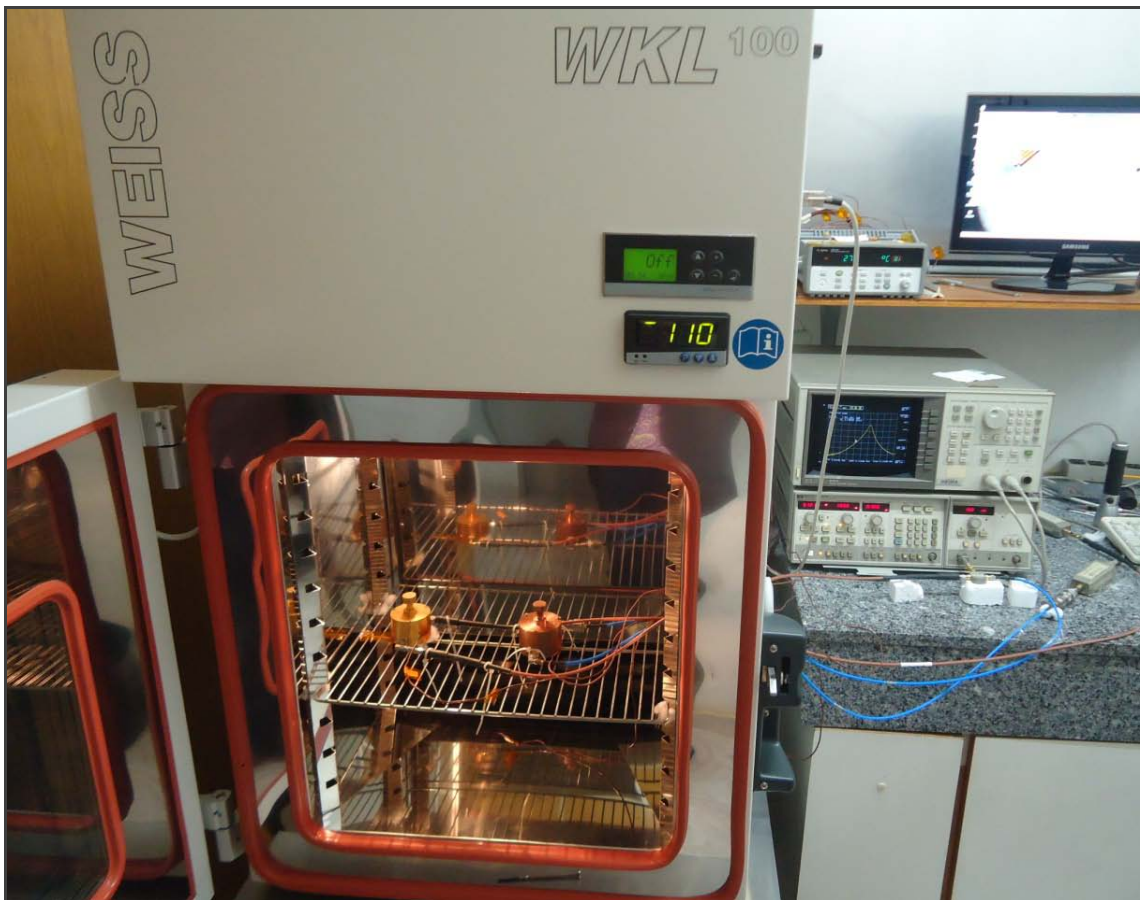
Figura 3.10 – Montagem de experimento em câmara térmica para a medição do coeficiente térmico da frequência de ressonância.
