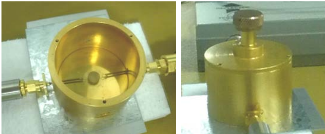
Figura 3.5 – Caixa de testes utilizada para a determinação da constante dielétrica.
