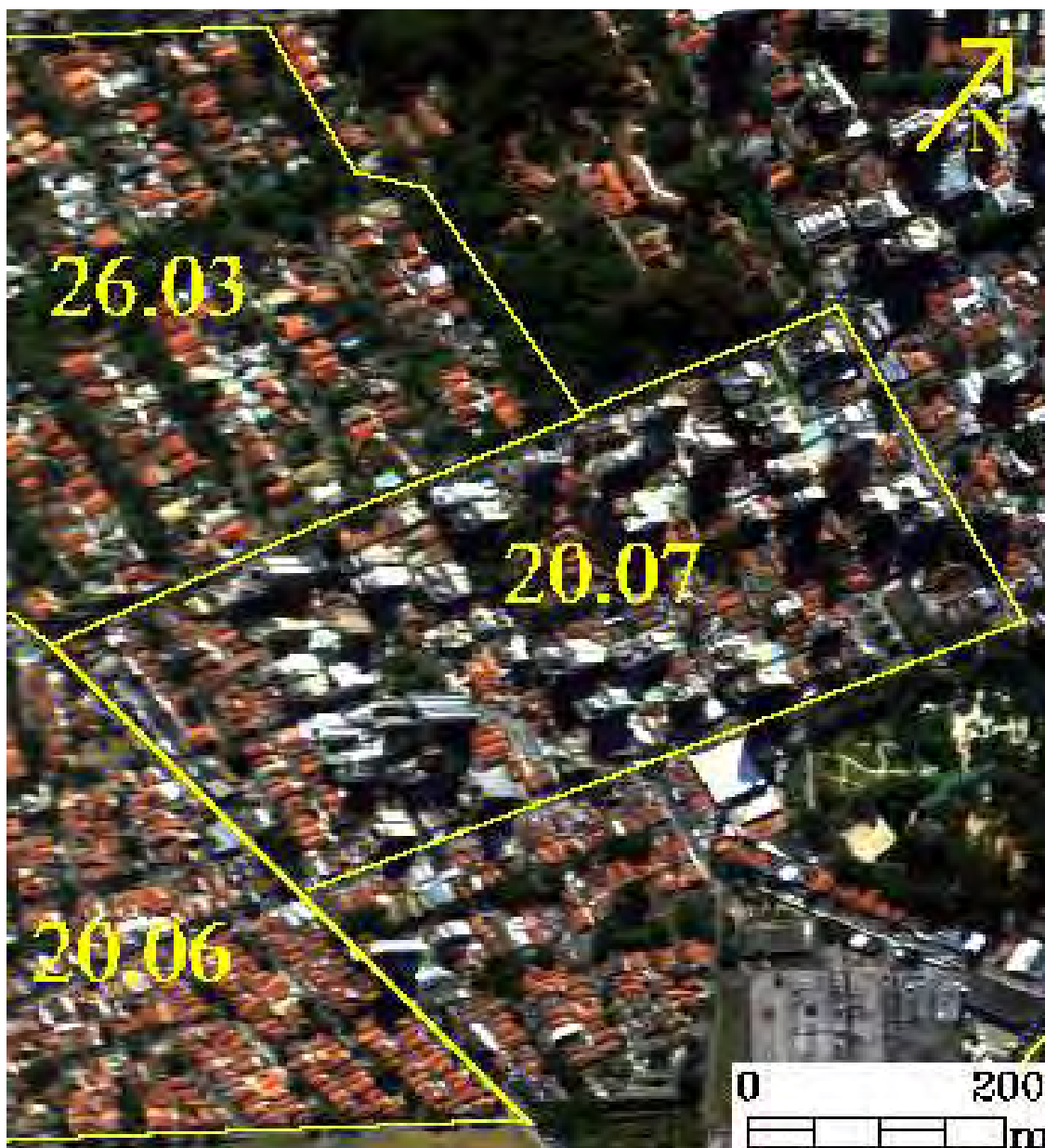
Figura 4.22 – Imagem em composição colorida RGB (bandas 8, 5 e 2 do HSS) com detalhamento dos subsetores residenciais definidos como exemplos para avaliação da relação entre a temperatura e os materiais urbanos.
