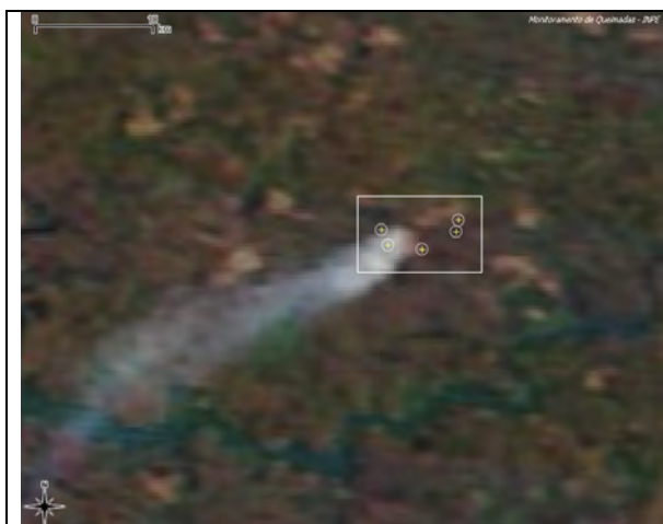
Figura 10.1 – Imagem MODIS do dia 24/jun/2011, com cinco focos de queima TERRA-M-T e TERRA-T, comprovando a queimada por meio da pluma de fumaça que se origina nos próprios focos.
