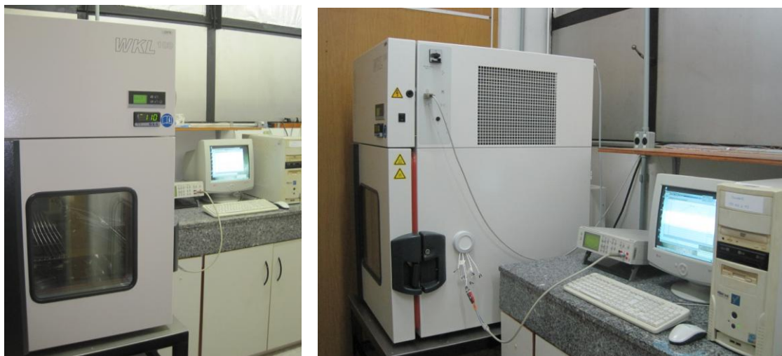
Figura 3.5 – Fotos da câmara climática acoplada à ponte RCL para medição da capacitância dos elementos sensores em função da umidade relativa do ar.
