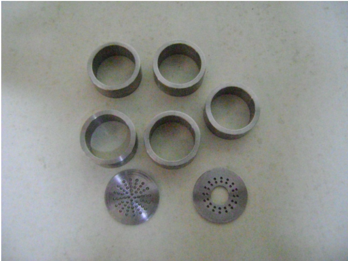
Figura 3.4- Telas e anéis do leito catalítico.
