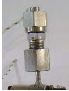
Figura 3.3- Sistema de injeção.
